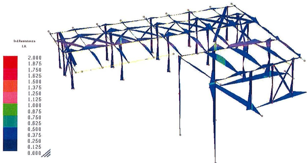
Fig. 31: Indici di resistenza a presso-flessione elementi in carpenteria metallica [valori < 1 = verifica soddisfatta]
