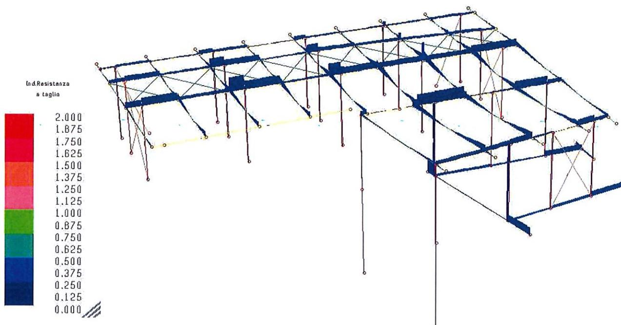
Fig. 32: Indici di resistenza a taglio-torsione elementi in carpenteria metallica [valori < 1 = verifica soddisfatta]
